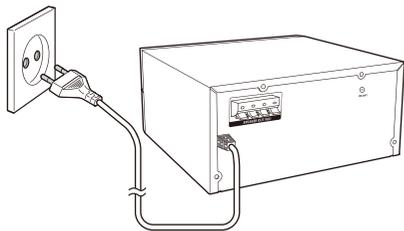
Ligue o cabo de alimentação à tomada de parede.
