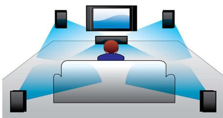
O decodificador integrado Dolby Digital elimina a necessidade de decodificador externo, processando os seis canais de informações de áudio para fornecer uma experiência de som surround de alta qualidade e uma sensação incrivelmente natural de ambientação e realismo dinâmico. O Dolby Pro Logic II oferece cinco canais de processamento de som de alta qualidade de qualquer origem de áudio estéreo.
