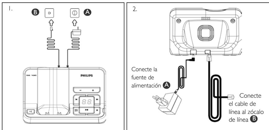
3. Conecte el otro extremo del cable de línea al zócalo de la línea telefónica y el otro extremo del cable de alimentación a la toma de corriente.
