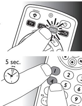
5 Pritisnite tipku
