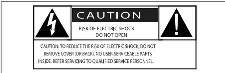
위의 '번개' 표시는 장치 내의 미절연 소재로 인해 감전의 위험이 있음을 나타냅니다. 가족의 안전을 위해 덮개를 열지 마십시오. '느낌표'는 작동 및 유지관리 문제를 방지하기 위해 별첨 설명서를 읽어야 하는 기능을 나타냅니다. 경고: 화재 또는 감전을 방지하려면 장치에 빗물이나 물기가 닿지 않도록 하고 꽃병 등의 액체가 들어 있는 물체를 장치 위에 놓지 마십시오. 주의: 감전 사고를 방지하려면 플러그를 완전히 꽂으십시오. (전극형 플러그를 사용하는 지역: 감전 사고를 방지하려면 폭이 넓은 플러그를 폭이 넓은 슬롯에 꽂으십시오.)
