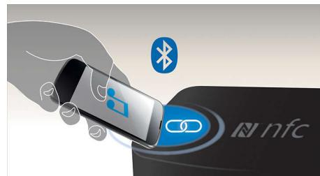
Технология NFC (Near Field Communications) позволяет выполнять подключение устройств по Bluetooth одним касанием. Поднесите смартфон или планшетный ПК с поддержкой NFC к АС и коснитесь поля NFC, чтобы включить систему. Установите Bluetooth-подключение и запустите потоковую передачу музыки.
