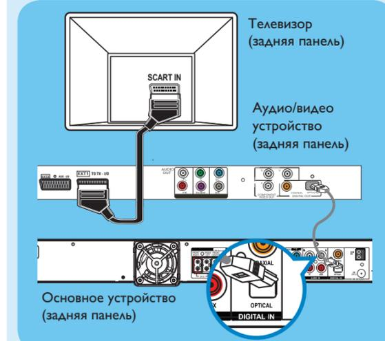
**Примечание.** Запустите воспроизведение на устройстве. Последовательно нажимайте кнопку DISC/DI на пульте ДУ, до появления сообщения OPTI IN (Оптический вход).
