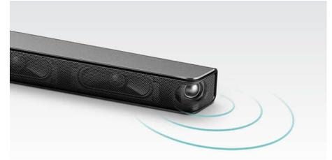
高音喇叭以 45 度角設計，向側面發送高頻，放大音場及高音頻。配合前置驅動器、角度高音喇叭及 Ambisound 專有處理及音效技術，提供更廣闊的音效。
