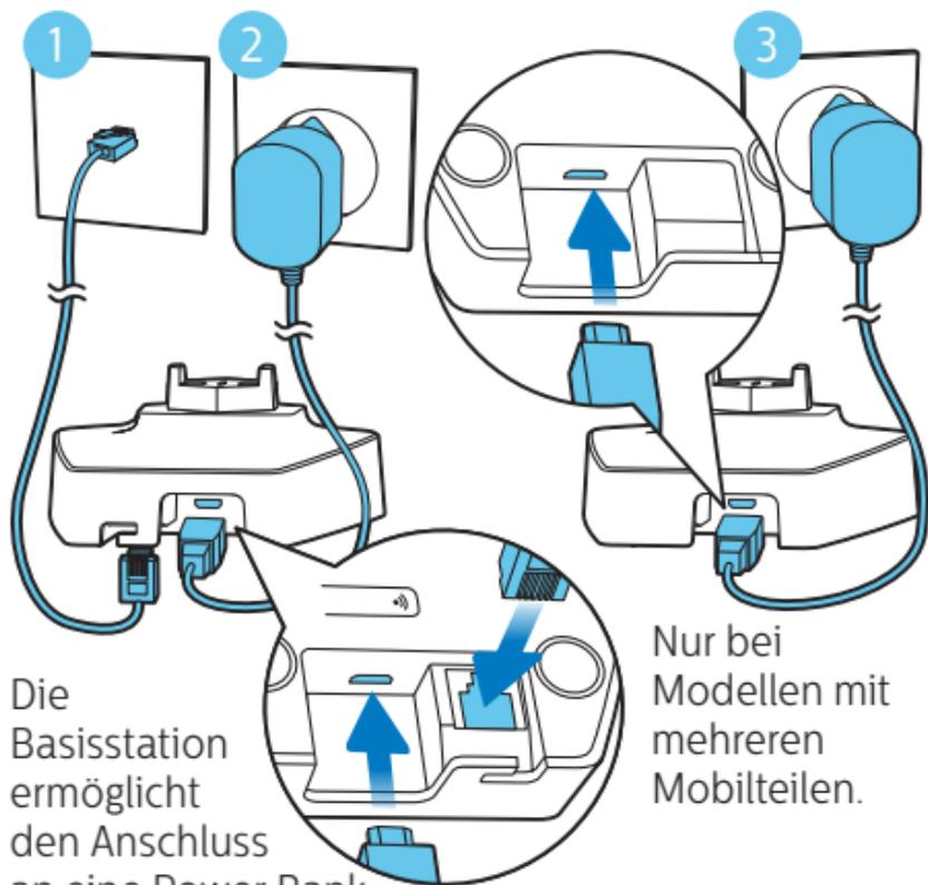
Die Basisstation ermöglicht den Anschluss an eine Power Bank als alternative Stromquelle während eines Stromausfalls.
