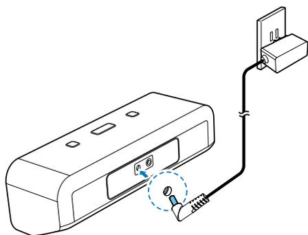
Collegare l'alimentatore CA: un'estremità alla presa di alimentazione sul retro dell'unità e l'altra a una presa a muro.
