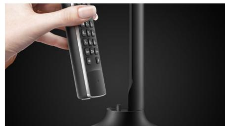
Los imanes de ajuste preciso y fuerza optimizada se encuentran en la parte superior del microteléfono y en la base para garantizar una conexión segura del teléfono en una posición vertical estable. El hueco perfectamente diseñado en la base no solo sirve como distintivo de su atractivo diseño, sino que también ayuda al usuario a coger fácilmente el terminal.
