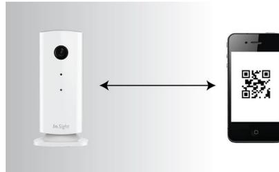
Die schnelle und einfache Installation ermöglicht Ihnen, die kabellose InSight Heimkamera mit einem iPhone oder iPad zu koppeln. Positionieren Sie das Bild des QR-Codes vor die Kameralinse, um die InSight App zu aktivieren. Die Kamera ist betriebsbereit, wenn das Licht grün leuchtet.
