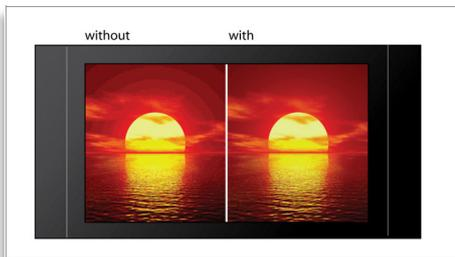
12 位视频 DAC 是一种高级的数模转换器，可以保留原始画质的每一处细节。它可以显示出微妙的图案阴影和平滑的色彩过渡，从而产生更加绚丽而自然的画面。而在使用大尺寸的屏幕和投影仪时，常见的 10 位 DAC 所产生缺陷就显得非常突出。
