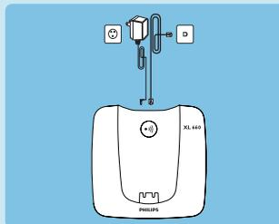
2. Telefon- und Netzkabel dann an den entsprechenden Buchsen auf der Unter- bzw. Rückseite der Basisstation anschließen.
