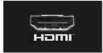
HDMI は、デジタル HD ビデオだけでなく、デジタルマルチチャンネルオーディオを伝送することができるダイレクトデジタル接続です。アナログ信号への変換を排除することで、ノイズから完全に解放された完璧な画質と音質を実現します。HDMI は DVI と完全に後方互換性があります。
