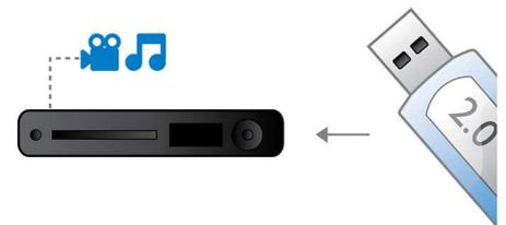
L'USB (Universal Serial Bus) est un protocole permettant de relier facilement des ordinateurs, des périphériques et des équipements électroniques grand public. Les appareils USB ultrarapides ont un taux de transfert de données allant jusqu'à 480 Mbit/s (il était de 12 Mbit/s sur les premiers appareils USB). Avec le port USB 2.0 ultrarapide, vous n'avez qu'à brancher votre appareil USB, sélectionner un film, un titre ou une photo et lancer la lecture.
