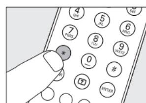
**6** Na originálním ovladači stiskněte a držte tlačítko požadované funkce. Tlačítko držte tak dlouho, až kontrolka TV LED zhasne a pak dvakrát blikne.
