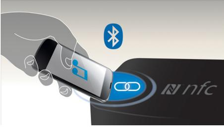
Pasangkan perangkat Bluetooth dengan teknologi NFC (Near Field Communications) satu sentuhan dengan mudah. Sentuh ponsel pintar atau tablet yang dilengkapi NFC pada area NFC speaker untuk mengaktifkan speaker, mulai pasang Bluetooth, dan mulai streaming musik.
