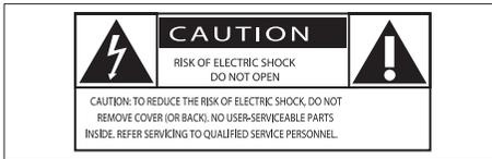
El símbolo del rayo indica que los componentes sin aislamiento dentro de la unidad pueden generar descargas eléctricas. Para la seguridad de todas las personas de su hogar, no retire la cubierta del producto.
