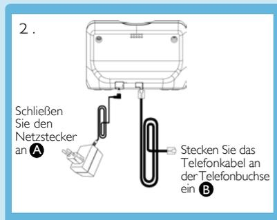
3. Stecken Sie das andere Ende vom Telefonanschlusskabel an der Telefonanschlussbuchse und das andere Ende des Netzanschlusskabels an der Netzsteckdose ein.
