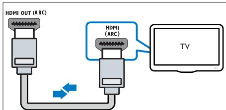
**1** Жылдамдығы жоғары HDMI кабелін пайдаланып, SoundBar жүйесіндегі **HDMI OUT (ARC)-TO TV** коннекторын теледидардағы **HDMI ARC** коннекторына жалғаңыз.
