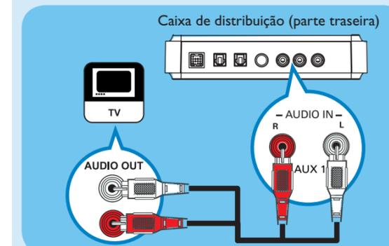
**Nota** Para ouvir a saída de áudio dessa conexão, pressione **AUX/DI/MP3 LINK** várias vezes até que 'AUX1 INPUT' seja exibido no display.
