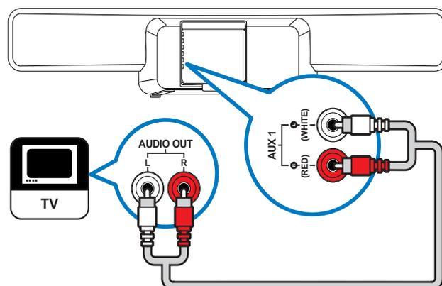
Raccordement audio avec plusieurs appareils :
