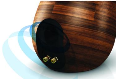
Încărcătura acustică a sistemului bass-reflex utilizează un tub de bas acordat la volumul acustic al boxei, pentru a reproduce un bas adânc din incinte compacte. Tubul de bas profilat, proiectat cu atenție, facilitează circulația aerului și permite obținerea unui bas adânc și de impact, chiar și la volume puternice și minimizează în același timp turbulențele de aer care pot provoca distorsiuni.
