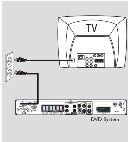
**Nachdem alles vorschriftsmäßig angeschlossen ist, das Wechselstromnetzkabel an die Steckdose anschließen.**
