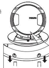
→ K indikátoru nabíjení svítí červeně (probíhá nabíjení). Nabíjení začíná.
