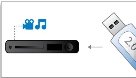
El bus serial universal o USB es un protocolo estándar que permite conectar fácilmente computadoras, periféricos y equipos electrónicos de consumo. Los dispositivos USB de alta velocidad tienen una velocidad de transferencia de hasta 480 Mbps, a diferencia de los 12 Mbps de los USB originales. Con Link USB 2.0 de alta velocidad, todo lo que tienes que hacer es conectar tu USB, seleccionar una película, música o fotografía, y reproducir.
