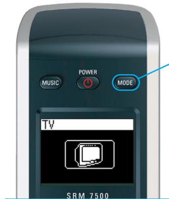
Pulse **MODE** en su SRM7500 para utilizarlo como mando a distancia universal. El icono de dispositivo del último dispositivo seleccionado aparecerá en la pantalla.
