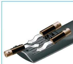
Coloque las 3 pilas en el compartimento de las pilas.
