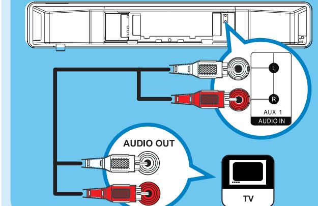
請注意 若要聆聽此連線的音訊輸出，請重複按下 AUX/DI /MP3 LINK，直到面板上顯示「AUX1 INPUT」(AUX 1 輸入) 為止。
