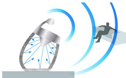
Il rivestimento posteriore ricurvo dalle linee ricercate di questo sistema docking per altoparlanti crea una struttura acustica efficace per una riproduzione sonora ottimale. Le curve semplici rafforzano la rigidità della cassa degli altoparlanti riducendo in maniera sensibile la risonanza interna ed eliminando le vibrazioni e la distorsione audio. Potrai così ascoltare un audio cristallino con degli altoparlanti dal look mozzafiato.
