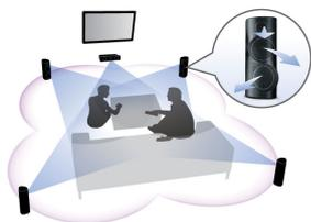
Gli altoparlanti 3D angolari sono dotati di driver angolari per produrre l'audio non solo anteriormente ma anche sui lati creando un'area di diffusione più ampia per un audio surround più coinvolgente come al cinema.
