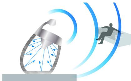
这款飞利浦音乐基座具有精心设计的曲线后盖, 可创造高效的声学结构, 实现声音再现。清晰的曲线加固了扬声器, 明显减少了内部共振, 消除了声音震动和失真。您只需享受精美扬声器带给您非凡的清晰音质即可。
