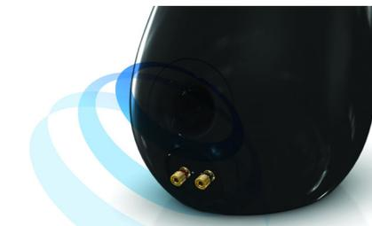
低音反射声载荷采用低音导管调谐音箱的音量, 以便通过小巧的音箱再现深沉的低音效果。精心设计成型的低音导管有助于空气流动, 形成深沉强劲的低音, 即使在较大音量下也如此, 同时最大限度地减少可能造成失真的空气干扰。
