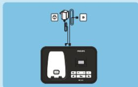
2. Conecte el cable de línea y el cable de alimentación a sus conectores correspondientes en la parte posterior de la estación base.
