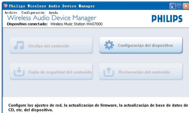
En el submenú de la configuración del dispositivo, puede consultar la información del sistema, gestionar la configuración de red, actualizar el firmware y consultar la conexión del dispositivo con la red externa.
