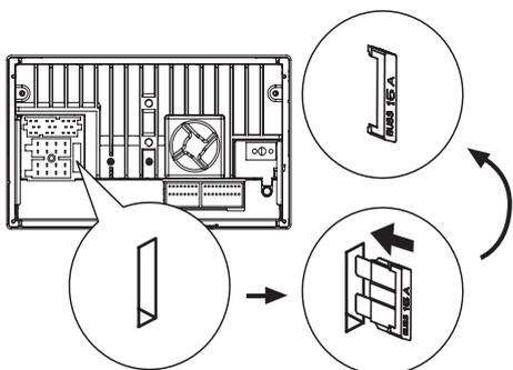
如果更换后保险丝立即熔断，则可能存在内部故障。在这种情况下，请咨询 Philips 经销商。
