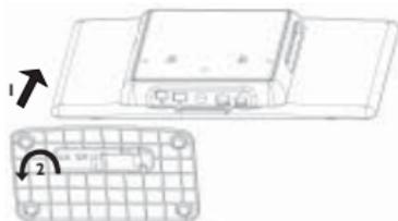
**Nota:** Cuando instale el televisor en la pared (consulte la sección Montaje en pared), quite el soporte. Para ello, levante el pasador y gírelo en el sentido de las agujas del reloj.
