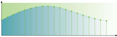
192KHz örnekleme, orijinal ses eğrilerinin doğru sunumunu elde etmenizi sağlar. 24 bit
