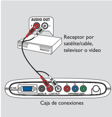
Puede conectar un dispositivo de audio/vídeo analógico (por ejemplo, receptor por satélite/cable, televisor o vídeo) a la caja de conexiones para utilizar las funciones de sonido Surround del sistema de audio Home Theatre.
