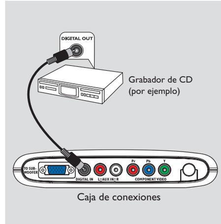
Puede conectar un dispositivo de audio digital (por ejemplo, un grabador de CD) a la caja de conexiones para poder utilizar las funciones de sonido Surround del sistema de audio Home Theatre.
