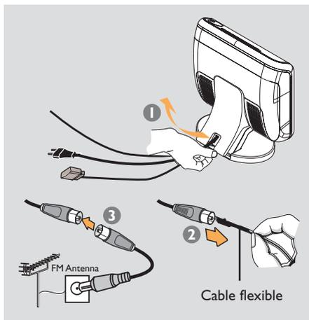
Si la recepción de FM es débil, puede utilizar un cable FM coaxial (no suministrado) para conectar el cable FM 75 coaxial oculto en la cubierta posterior directamente al terminal de antena FM externa.
