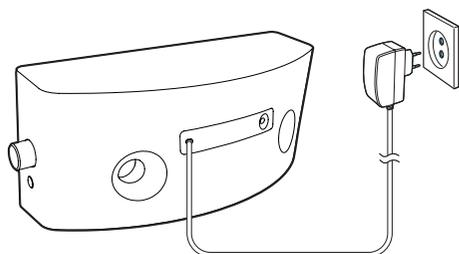
Collegare il cavo di alimentazione CA alla presa di corrente a muro.
