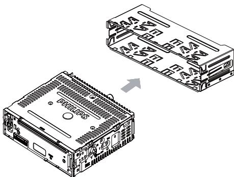
**5** Установите корпус в приборную панель и отогните язычки наружу, чтобы закрепить корпус.
