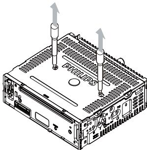
**4** С помощью инструментов для разборки, входящих в комплект поставки, снимите корпус устройства.
