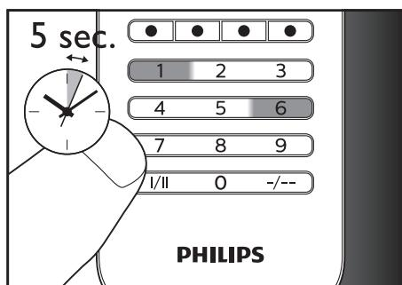
**3** Univerzalni daljinski upravljalnik usmerite proti napravi. Nato pritisnite in sprostite , da začnete z iskanjem kode za vašo blagovno znamko. Univerzalni daljinski upravljalnik med iskanjem vsaki 2 sekundi pošlje drug infrardeči signal, ki ga označuje rdeče utripanje indikatorja.
