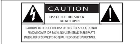
Ce symbole éclair signifie que les composants non isolés de votre appareil peuvent provoquer une décharge électrique. Pour la sécurité de votre entourage, ne retirez pas le couvercle du produit.
