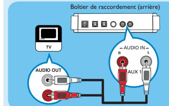
**Remarque** Pour diffuser le son provenant de la sortie audio de l'appareil connecté, appuyez plusieurs fois sur **AUX/DI/MP3 LINK** jusqu'à ce que « AUX1 INPUT » (Entrée AUX 1) apparaisse sur l'afficheur.
