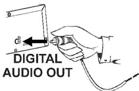
An der Rückseite des DVD-Recorders befinden sich zwei digitale Audioausgangsbuchsen **OPTICAL AUDIO OUT** für ein optisches Kabel und **COAX OUT** für ein koaxiales Kabel (Cinch-Kabel).
