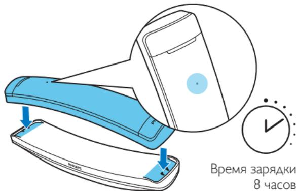
Заряжайте телефонную трубку, установив ее в любом направлении. LED-индикатор на задней панели трубки мигает один раз.
