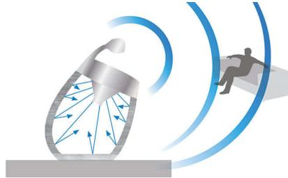
Прецизно проектираният извит заден капак на тази тонколоната за поставяне Philips създава високо ефективна акустична структура за възпроизвеждане на звука. Тази елегантна извивка подсилва здравината на кутията на тонколоната, намалява значително вътрешния резонанс и премахва вибрациите и изкривяванията на звука. Можете да се наслаждавате на превъзходен кристално чист звук от тази тонколоната с главозамайващ дизайн.
