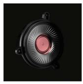
分層動態控制 (LMC) 驅動器採用多層振膜,包有一層阻尼膠。這些層面與凝膠形成靈活的邊界,吸收並抑制任何誇張的頻率,帶來平穩和平坦的頻率響應。高頻率的聲音更加平衡及自然,音量範圍更細緻。
