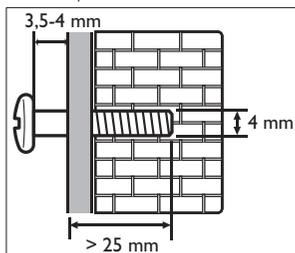
Veja a ilustração no guia de iniciação rápida sobre como montar a Soundbar na parede
