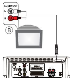
**B** Per ascoltare il televisore attraverso il sistema, utilizzare un cavo cinch (non in dotazione) per collegare la presa **AUX IN (3,5 mm)** alla presa **AUDIO OUT** sul televisore.
