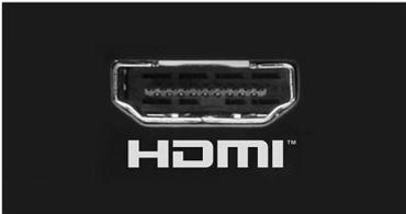
HDMI es una conexión digital directa que puede transmitir video de alta definición y audio multicanal digital. Como no convierte la información al formato analógico, ofrece una calidad de imagen y sonido excelente y sin ruidos. HDMI es totalmente compatible con DVI.
